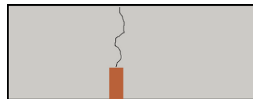
Imaxe 2: xunta de contracción mediante indución desde abaixo en formigón monocapa
