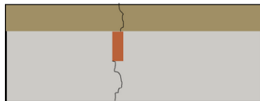
Imaxe 1: xunta de contracción mediante indución intermedia en formigón bicapa
