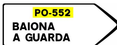
Exemplo de panel frecha nun treito da estrada convencional PO-552, categorizado funcionalmente como rede local
