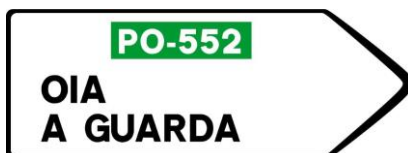
Exemplo de panel frecha nun treito da estrada convencional PO-552, categorizado funcionalmente como rede complementaria
